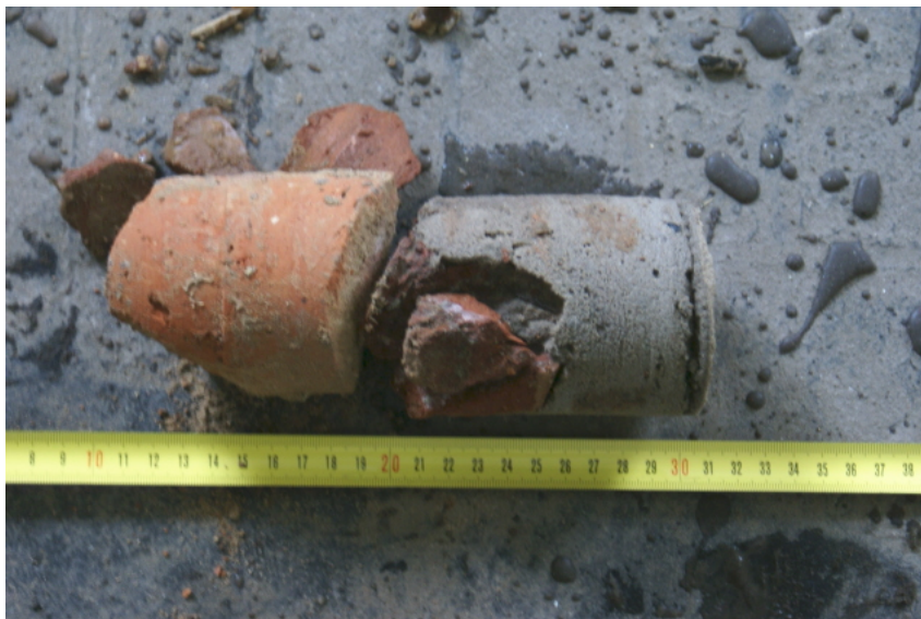
Fot. 12. Rdzeń wycięty z podkładu na parterze pałacu. Wylewka cementowa o grubości 6 – 10 cm została ułożona na warstwie gruzu ceglanego
